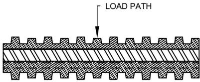
STYLE A - STEEL PLATE BONDED BETWEEN RIBBED AND SINGLE SIDED PADS
